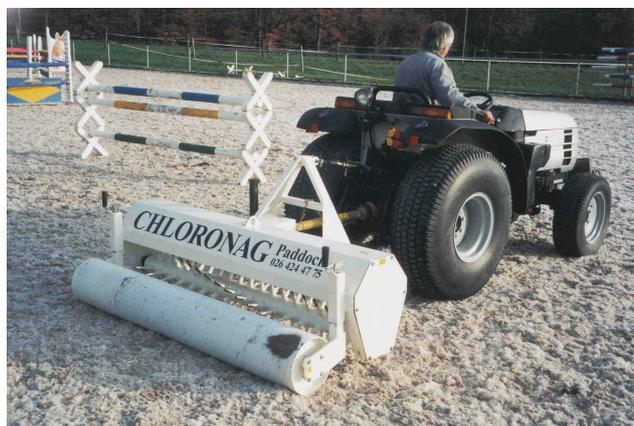
Chloroplaner, das Gerät für den Unterhalt
